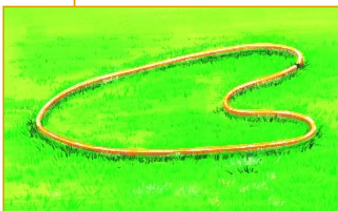
Form- und Größenbestimmung mittels eines Wasserschlauches
